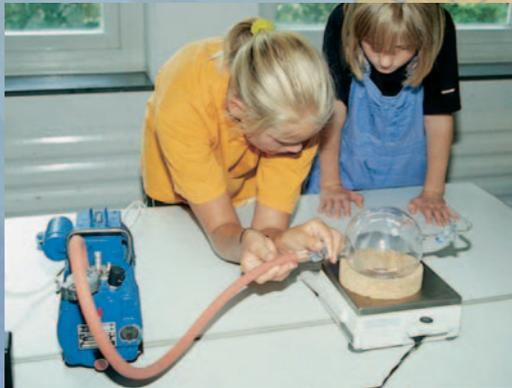
a) Wie schwer ist kalte Luft? Bestimme die Dichte von Luft bei normaler Temperatur. Benutze dazu eine ▶ Gaswägekugel.
