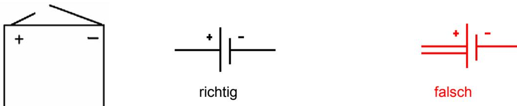
Bei der Batterie gibt es eine Besonderheit zu beachten: An der Flachbatterie selbst ist die Metallzunge des Plus-Pols immer kürzer als die des Minus-Pols. Beim Schaltzeichen bedeutet der längere Strich jedoch Plus-Pol!
