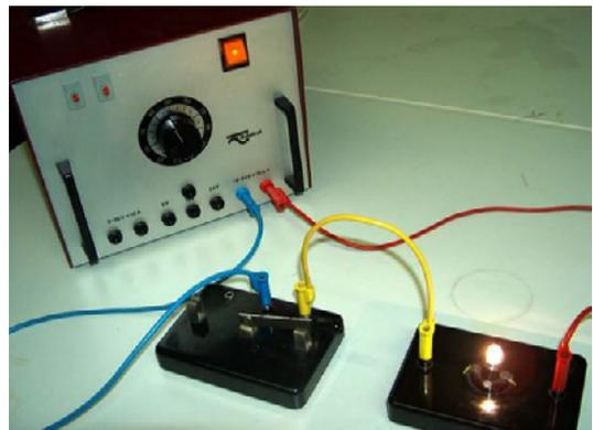
Mit diesen einfachen Kenntnissen lässt sich schon Morse. Hierzu benötigt man das dargestellte Material (Bild oben) aus der Sammlung oder entsprechend eine Lampe, eine Batterie und einen Taster aus dem Experimentier-Set. Das Morsealphabet steht auf dem gleichnamigen Arbeitsblatt. Unten auf dem Blatt steht mit Morsezeichen: Viel Spass!
